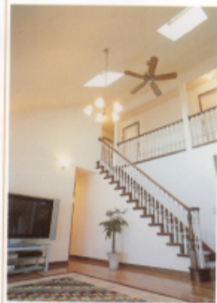
リビング吹き抜け。天井は屋根形状に合わせて均配天井とし、2つの天窓からの採光も十分。
